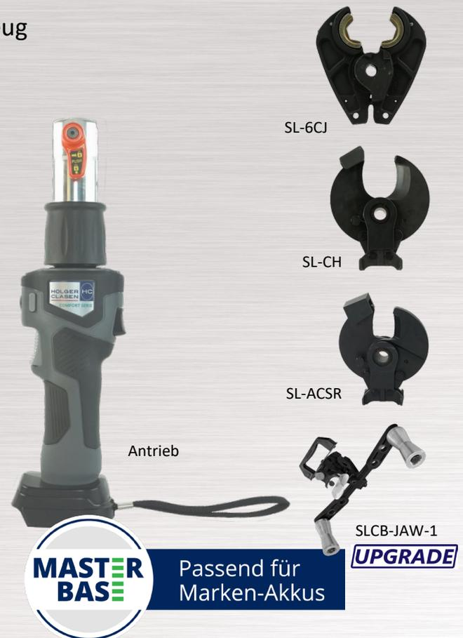
Pressen, Schneiden und Biegen: Das Werkzeug schneidet Cu-Kabel und Freileitung, verpresst Kabelschuhe und Verbinder mit schmalen C-Schalen-Presseneinsätzen (CS) bis 240 mm<sup>2</sup> nach DIN oder biegt Kabel bis 1000 mm<sup>2</sup>. Der Pull-Pin-Kopf sorgt für eine einfache und schnelle Montage. Das Werkzeug ist somit ideal für Elektromontage mit wechselnden Einsatzgebieten – mit Biegeaufsatz gerade bei Montagearbeiten im Schacht oder Elektroinstallationen in verwinkelten Bereichen.
